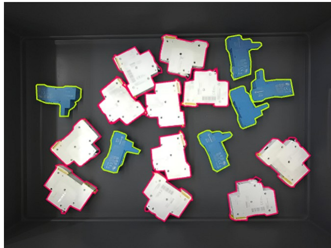
Εικόνα 3: Επισημασμένη εικόνα για την εκπαίδευση μοντέλου τμηματοποίησης
