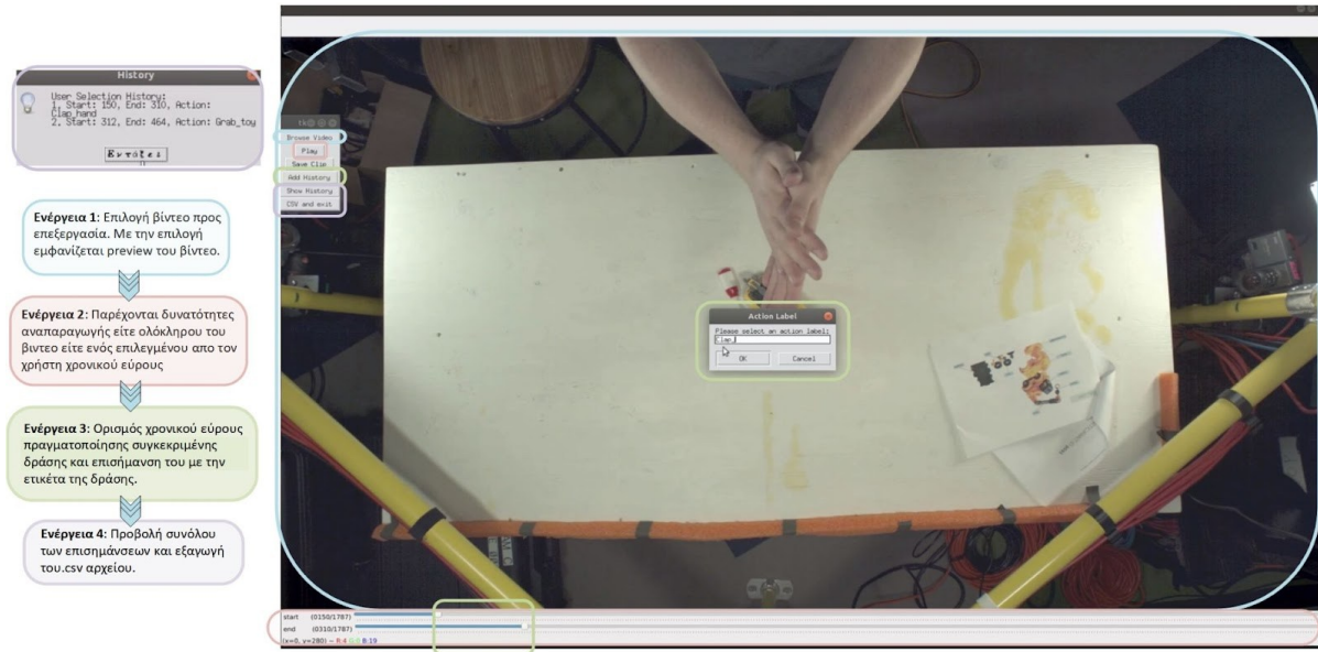
Εικόνα 135: Παράδειγμα χρήσης και δυνατοτήτων της διεπαφής επισήμανσης δεδομένων που αναπτύχθηκε στα πλαίσια της ενδιάμεση λύσης. Χρωματικές επισημάνσεις επιδεικνύουν τα σχετικά εργαλεία κάθε ενέργειας.
