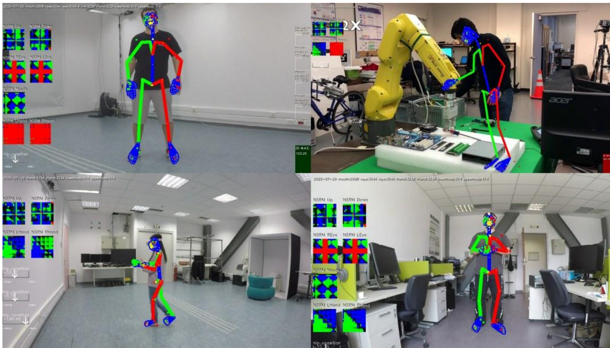
Εικόνα 70 Δοκιμές της εφαρμογής παρακολούθησης της αρθρωτής κίνησης του ανθρώπινου σώματος
