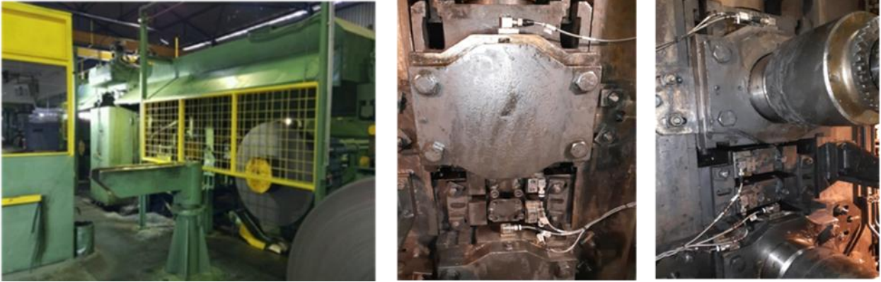
Εικόνα 31 Η μονάδα ψυχρής έλασης, η εμπρόσθια όψη των κυλίνδρων, και η οπίσθια όψη των κυλίνδρων
