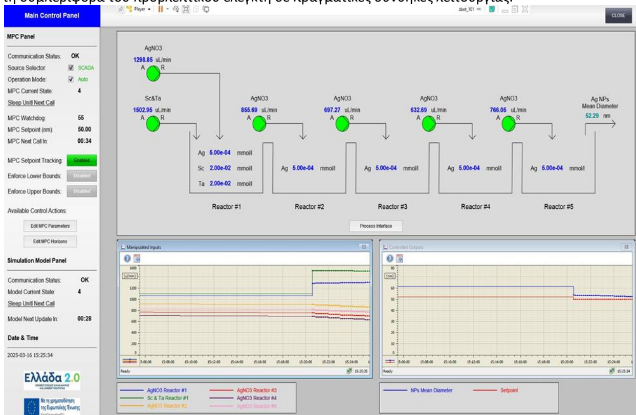
Εικόνα 100 Κεντρική οθόνη εφαρμογής εποπτικού ελέγχου SCADA
